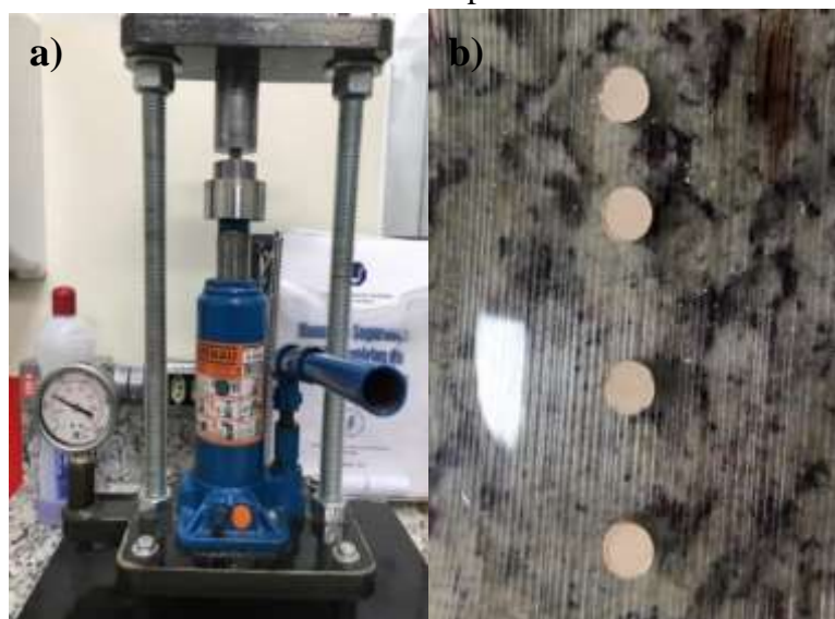
Figura 17: Equipamento e amostras: a) Prensa hidráulica 4 ton.; b) Materiais prensados em formato de pastilhas.
